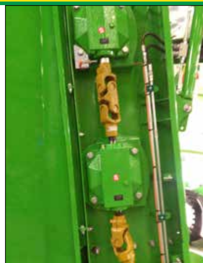
Napęd mechaniczny wałkiem kardana
