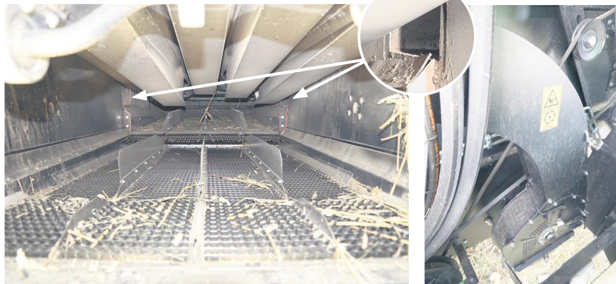
Po obu stronach kombajnu znajdują się minimłocarnie do domłacania kłosów. Omłócone w nich ziarno jest przekazywane bezpośrednio na podsiewacz (miejsca zaznaczone strzałkami), co eliminuje możliwość przeciążenia młocarni
