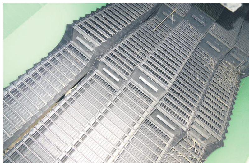
Wymłócona słoma przekazywana jest na pięć klawiszy wytrząsacza z czterema kaskadami. Charakterystyczne jest w nich to, że są zamontowane na łożyskach kulkowych, co ogranicza hałas i redukuje straty mocy
