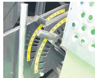
Klepisko bębna młócającego posiada niezależną regulację szczeliny wlotowej i wylotowej, co umożliwia utrzymanie najlepszych parametrów omlotu. Minimalna szczelina na wejściu wynosi 6 mm, na wyjściu 3 mm
