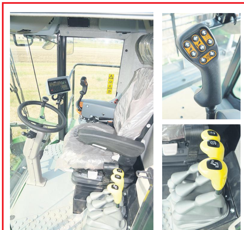
Kombajn Deutz-Fahr C5305 wyposażony jest w joystick służący do podnoszenia i opuszczania hederu oraz do obsługi nagarniacza. Do uruchamiania zespołu żniwnego, omlotowego oraz załączania rozładunku ziarna, wykorzystywane są dźwignie znajdujące się z lewej strony siedzenia operatora
