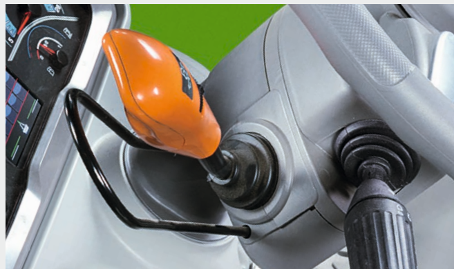
↑ Standard: rewers elektrohydrauliczny Powershuttle z możliwością regulacji szybkości reakcji w pięciu stopniach.
