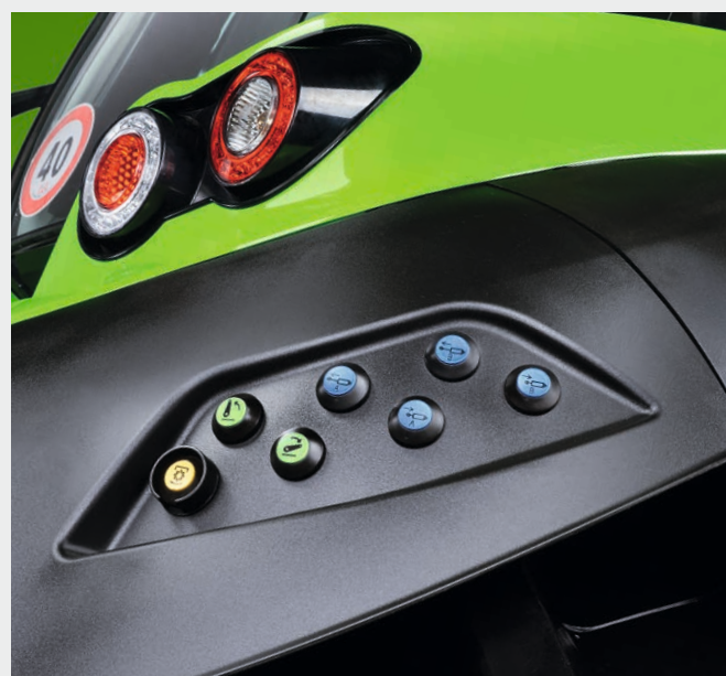
↑ Przyciski sterowania hydraulicką, WOM i podnośnikiem na błotnikach.
