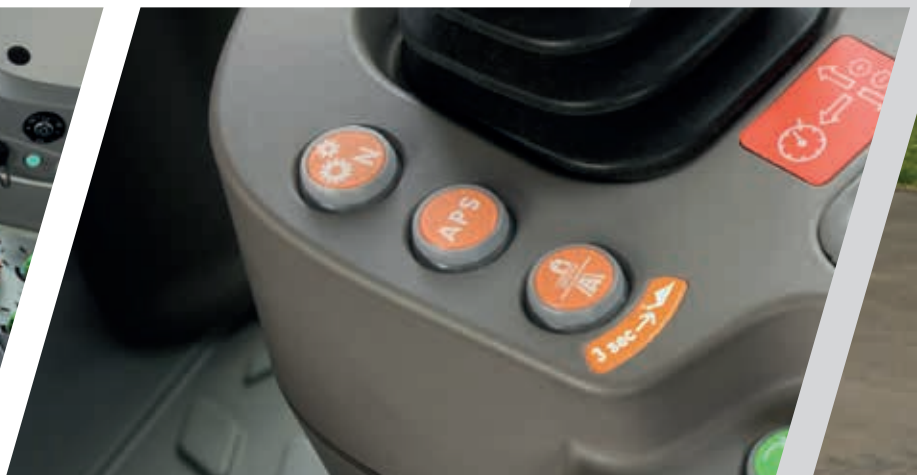
> Przycisk wyboru trybu pracy napędu: Transport, Pole i Reduktor.
