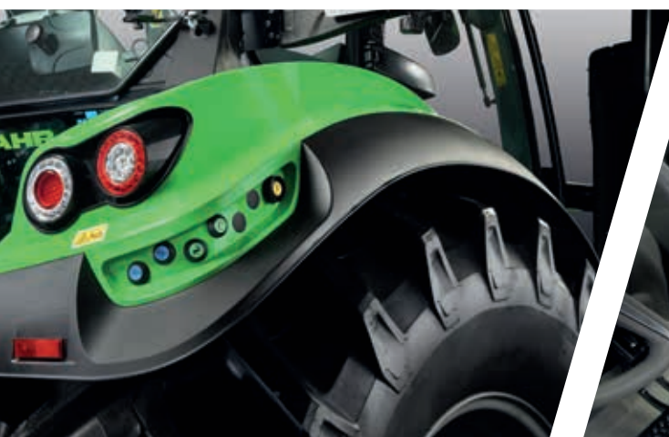
> Zewnętrzne przyciski sterowania podnośnika, WOM i hydrauliki po obu stronach kabiny.
