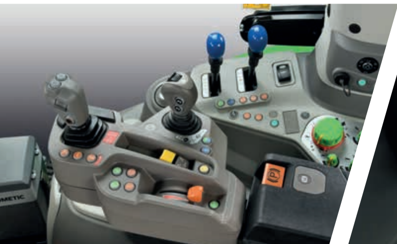
> Zaawansowany podłokietnik z 3 programowalnymi przyciskami i programowalnym pokrętkiem.
