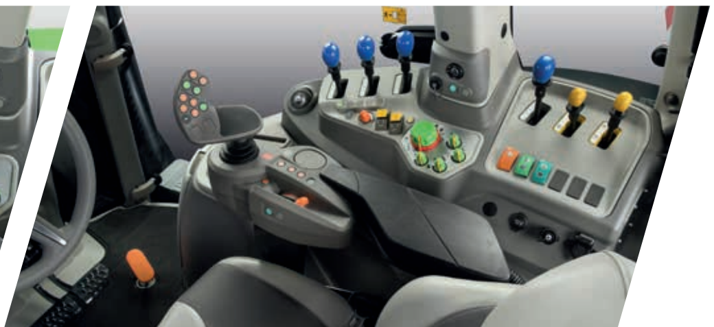
> MaxiVision z mechanicznie sterowaną hydrauliką (niebieskie dźwignie) w napędzie Powershift (duże zdjęcie) i RCshift (zdjęcie powyżej).
