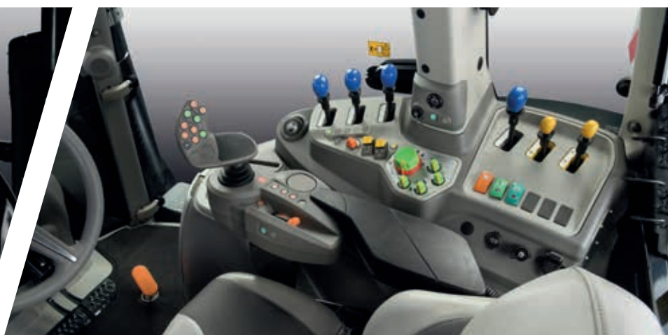
> Do czterech mechanicznych dźwigni sterowania. Wersja z dźwignią krzyżową dla dwóch obwodów także dostępna.
